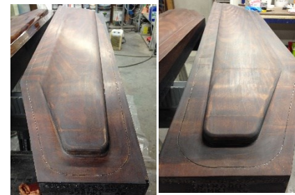
CP STAB Moule intrados et extrados de pale d'hélicoptère
