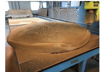
CP STAB Moule de parabole de satellite en cours d'usinage
