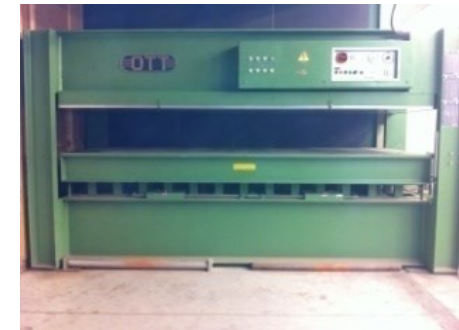
Presse à panneau 110°C/3,7 bar de 3300mm x 1300mm x 400mm
