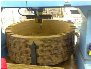
STAB MASSIF 1 er moule proto 180°C pour le réacteur de l'A350
