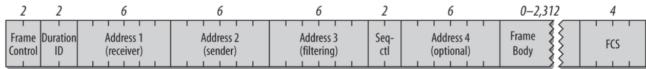
FIG. 11 : Structure d'une trame IEEE 802.11, [Gas09]
